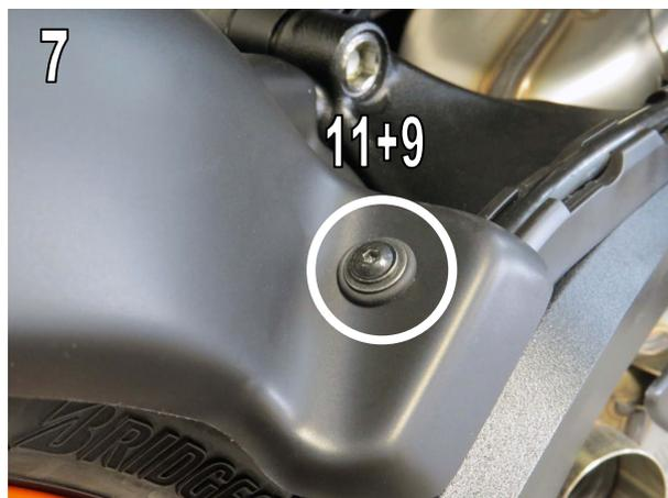
9. Befestigen Sie die Radabdeckung an den Befestigungspunkten des Kettenschutzes, wie in Abb. 8 gezeigt. / *Fit hugger to chain guard mounting points as shown in Fig. 8*
