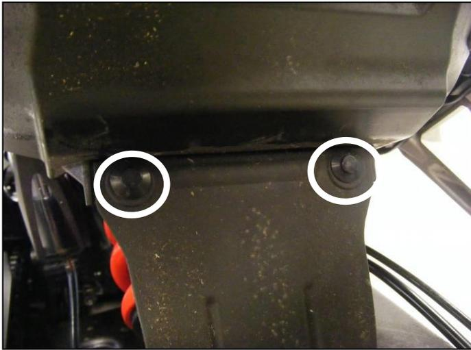
5. Entfernen Sie den Bremsleitungshalter
